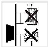
Monter l'onduleur sur une surface de montage stable et à même de supporter son poids en toute sécurité. Les parois en placoplâtre et les coffrages en bois sont interdits.
